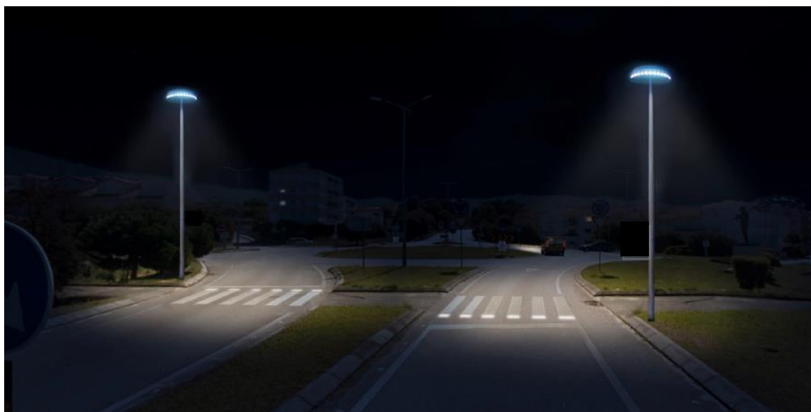
Figura - Passadeira existente a Norte com a localização de 2 colunas OMNIFLOW 70 com 8,0m de altura.
