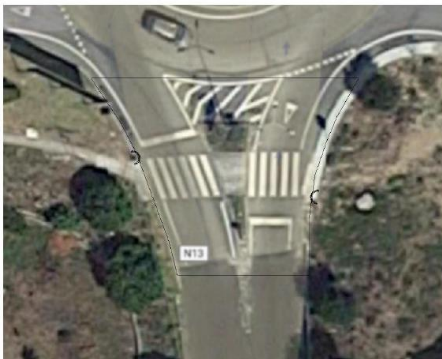
Figura - Passadeira existente a Sul com a localização de 2 colunas OMNIFLOW 70 com 8,0m de altura.
